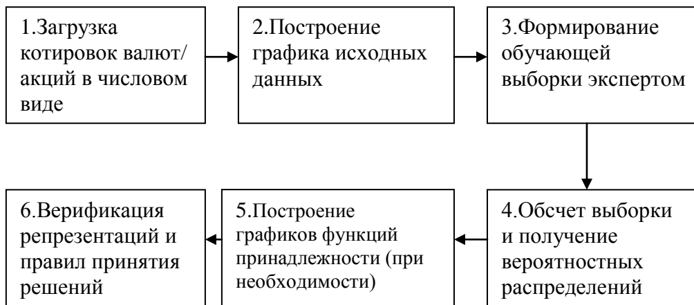
Рис. 3. Схема информационных потоков процесса анализа исторических данных в режиме машинного обучения по образцам (пункты 1,2,4,5 выполняются программой, пункт 3 выполняется экспертом, пункт 6 – инженером по знаниям).
